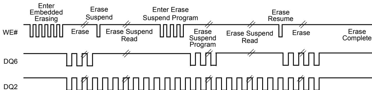
**Note:** The system may use OE# or CE# to toggle DQ2 and DQ6. DQ2 toggles only when read at an address within the erase-suspended sector.
