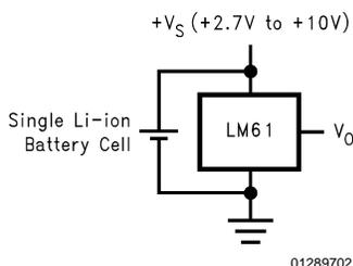
$$V_O = (+10\text{ mV}/^{\circ}\text{C} \times T\text{ }^{\circ}\text{C}) + 600\text{ mV}$$
