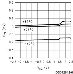
**$V_{\text{OS}}$  vs  $V_{\text{CM}}$
