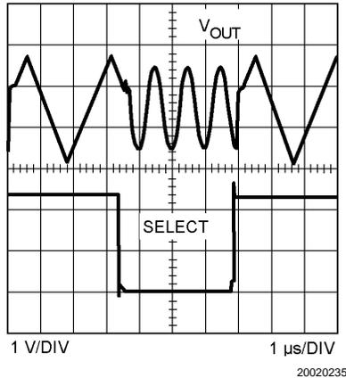
**FIGURE 6. 2:1 MUX Output**
