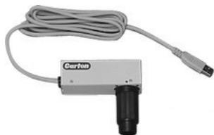
Высококонтрастная цветная ПЗС видеокамера **XR9507E** устанавливается на вертикальный оптический канал стереомикроскопа и обеспечивает передачу изображения в компьютер через порт USB. Интегрированный стереомикроскоп с возможностями цифрового микроскопа позволяет оперативно документировать и доставлять информацию о дефектах в системах тотального контроля качества.
