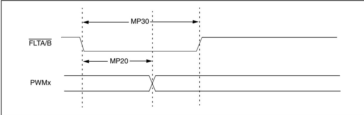
**FIGURE 23-13: MOTOR CONTROL PWM MODULE TIMING CHARACTERISTICS**
