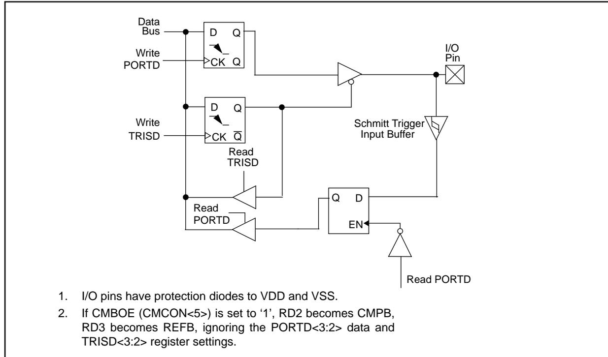
**FIGURE 5-10: BLOCK DIAGRAM OF PORTD<1:0> PINS**
